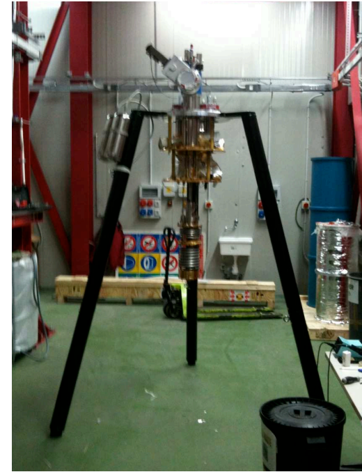
Dilution unit test setup @ LNGS
