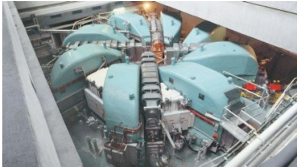
世界最大強度の陽子リングサイクロトロン @ PSI - 1.3 MW (2.2 mA) with a 590 MeV energy - 50.6 MHz frequency
